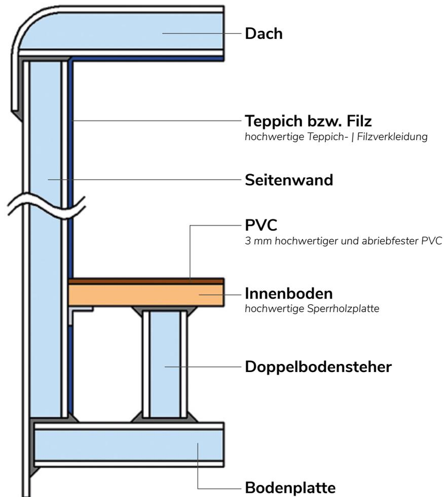
Unser gesamter Wohnmobilaufbau besteht aus einer hochstabilen GFK-Sandwich Konstruktion.
